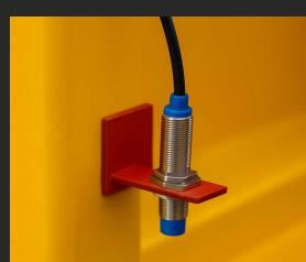
Los sensores inductivos del sistema de control automático son fácilmente extraíbles como indica la figura, con sistemas de tuerca y contratuerca para un desmontaje por calibración o mantenimiento rápido y preciso.
