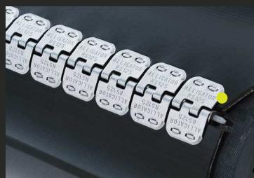
Para el desarme de la banda bastará con tirar del pasador para que la misma quede dividida y pueda extraerse ya sea para cambio, reparación, limpieza u otro. De la misma manera, bastara juntar la banda y cruzar un pasador para que quede armada, luego se hace el tensionado y estará lista para operar. El tiempo aproximado para esto una vez que se ha destensado la banda se calcula entre 60 y 90 segundos si no hubiere algún daño ajeno sobre la grapa.
