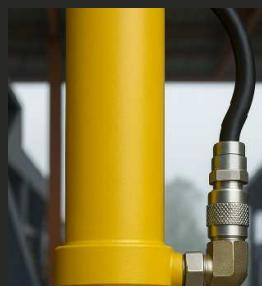
Todo el sistema viene equipado con ruptores rápidos por lo que la extracción de líneas de presión es instantáneo.
