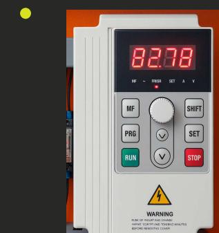
El proceso de calibración es extremadamente sencillo, bastará con girar la perilla hasta que considere el operador una velocidad confortable para operar. El sistema viene con un sistema de seguridad para no exceder los límites y hacer que la operación siempre sea segura.
