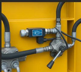
La calibración de la presión del sistema automático es también directo con manipulación de la perilla indicada. El sistema hidráulico viene pre seteado para operarlo con seguridad y dentro de parámetros controlados.
