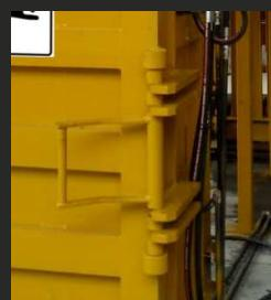
Cierre instantáneo con el mecanismo de enclavamiento directo. Solo requiere la aproximación de la puerta y el giro de la palanca. No requiere de mayor esfuerzo.
