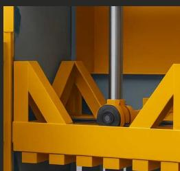
Sistema de desmontaje rápido de martillo. Solo se debe extraer el pin sujeto por una arandela tipo Seeger. Extracción en tiempo aproximado 120 segundos.
