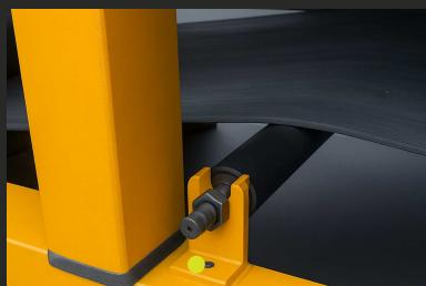
El montaje y desmontaje de los rodillos soporte, tensores y guía se ponen en posición y se ajusta la tuerca, siendo esta operación una de las sencillas en el montaje y mantenimiento del equipo, considerando que tiene dos puntos de apoyo, la operación es entre 15 y 20 segundos para un solo operario y hasta de menos de 10 segundos entre dos personas, una de cada lado.
