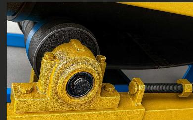
El sistema tensor que va unido obviamente al tambor de cola permite un fácil mantenimiento gracias al sistema quick changeover and setup puesto que lleva chumaceras cajeras (partidas) que permiten extraer el eje y los rodamientos de manera fácil con tanto solo extraer la carcasa, facilitando el cambio de los elementos rodantes sin tener que desarmar el tensor completo. Una operación que lleva entre 30 y 60 segundos por cada lado.
